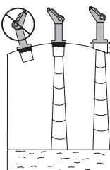
L'axe de transmission ne doit rencontrer aucune interférence telle soudure, échelon, tuyaux, ...
