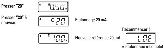
**Note :** L'étalonnage peut être effectué sans tenir compte du temps de réponse de la mesure.
