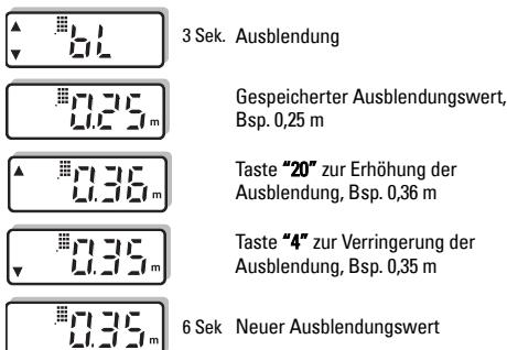
**Hinweis:** Der Durchlauf der angezeigten Werte kann beschleunigt werden, indem Sie die jeweilige Taste gedrückt halten, bis der gewünschte Wert erreicht ist.
