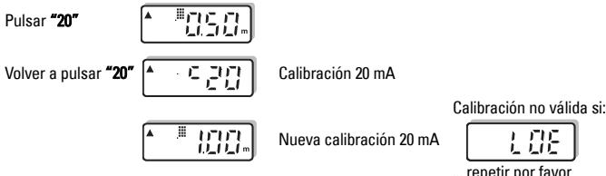
**Nota:** Al efectuar la calibración el aparato no procesa el tiempo de respuesta a la medición.
