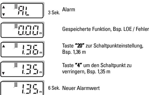
**Hinweis:** Der Durchlauf der angezeigten Werte kann beschleunigt werden, indem Sie die jeweilige Taste gedrückt halten, bis der gewünschte Wert erreicht ist.
