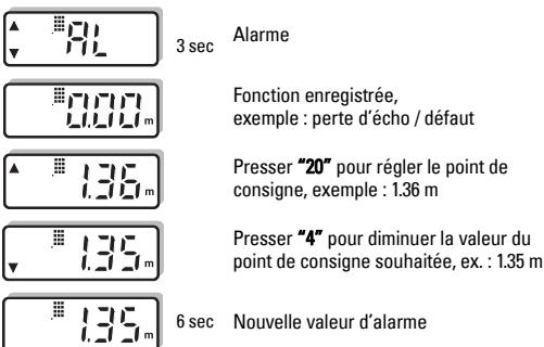
**Note :** Pour un étalonnage plus rapide, maintenir la touche pressée pendant le réglage de l'alarme, et relâcher une fois la valeur souhaitée obtenue.
