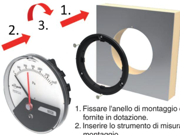
1. Fissare l'anello di montaggio con le tre viti fornite in dotazione.
