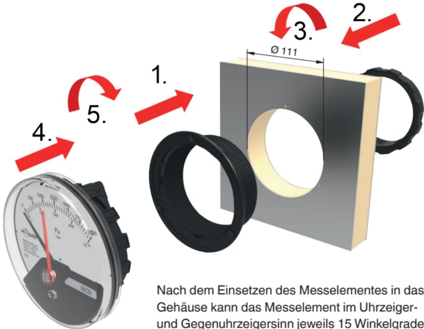
Nach dem Einsetzen des Messelementes in das Gehäuse kann das Messelement im Uhrzeiger- und Gegenuhrzeigersinn jeweils 15 Winkelgrade verstellt werden um eine exakte waagrechte Positionierung des Gerätes zu gewährleisten.
