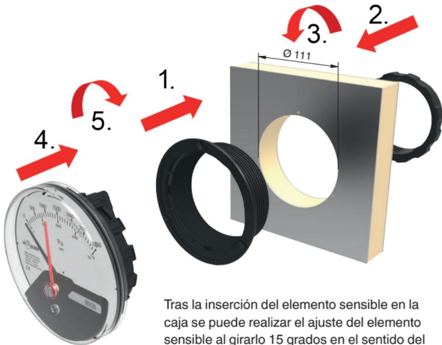
Tras la inserción del elemento sensible en la caja se puede realizar el ajuste del elemento sensible al girarlo 15 grados en el sentido del reloj o en sentido contrario para asegurar una posición horizontal del instrumento.
