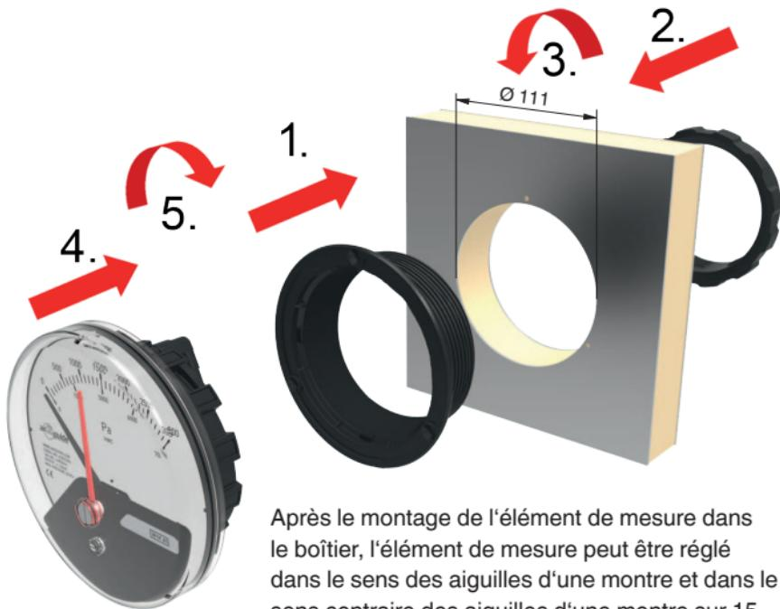
Après le montage de l'élément de mesure dans le boîtier, l'élément de mesure peut être réglé dans le sens des aiguilles d'une montre et dans le sens contraire des aiguilles d'une montre sur 15 degrés d'angle afin de garantir un positionnement horizontal précis de l'appareil.
