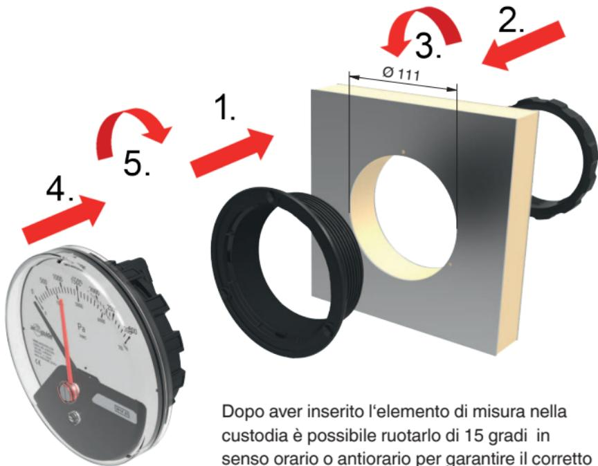
Dopo aver inserito l'elemento di misura nella custodia è possibile ruotarlo di 15 gradi in senso orario o antiorario per garantire il corretto posizionamento orizzontale dello strumento.
