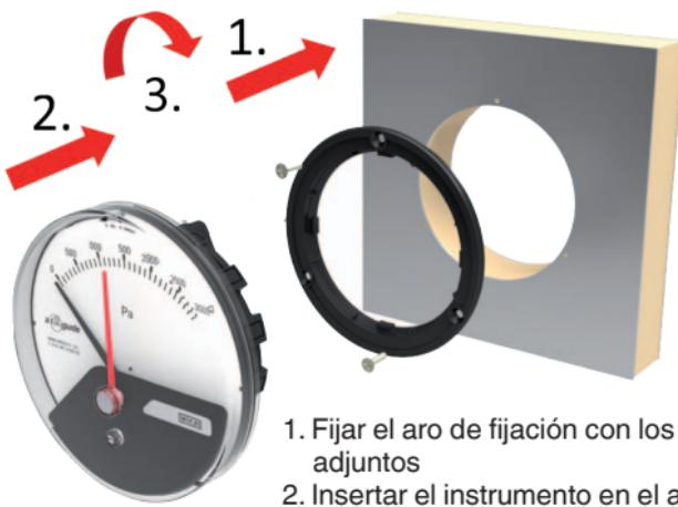
1. Fijar el aro de fijación con los tornillos adjuntos
