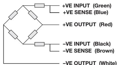
**Wiring Schematic Diagram**
